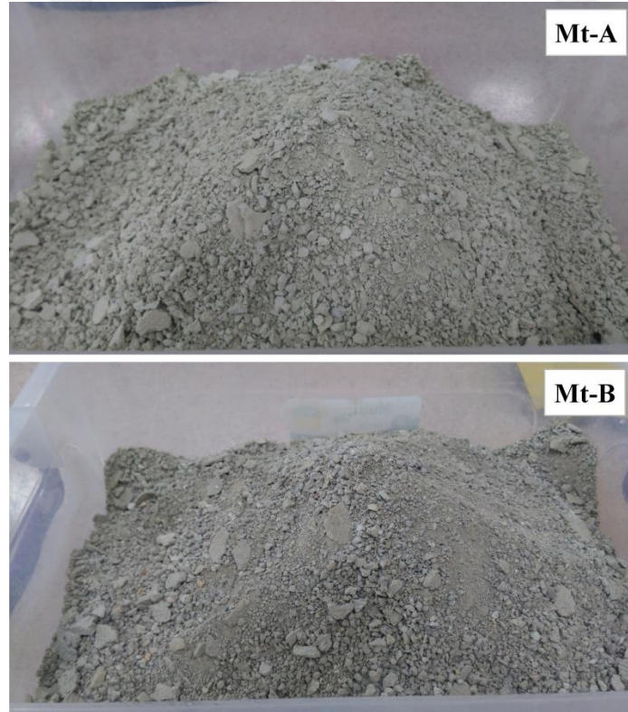
Şekil 7.1 Havada kurutulmuş ve boyutu küçültülmüş ham kil örnekleri.
