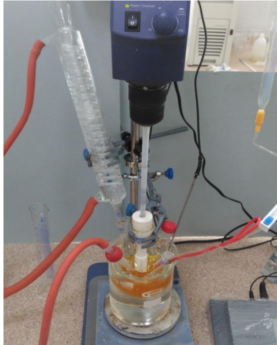
Şekil 7.8 Manyetit nano partikül (MNP) sentezinde kullanılan cam reaktör.
