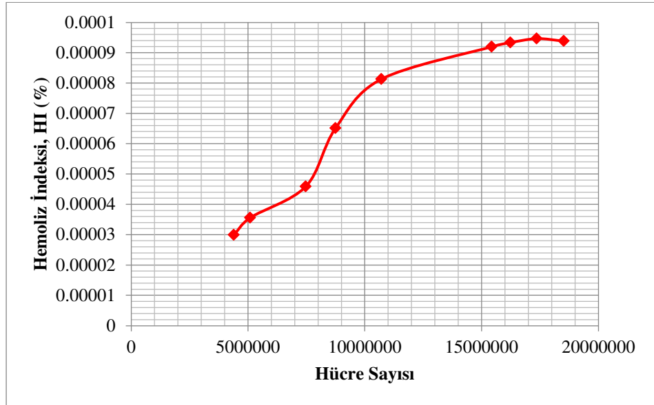
Şekil 3.8. FDA kan pompası doğrulama modeli için çözüm ağı bağımsızlık testi
