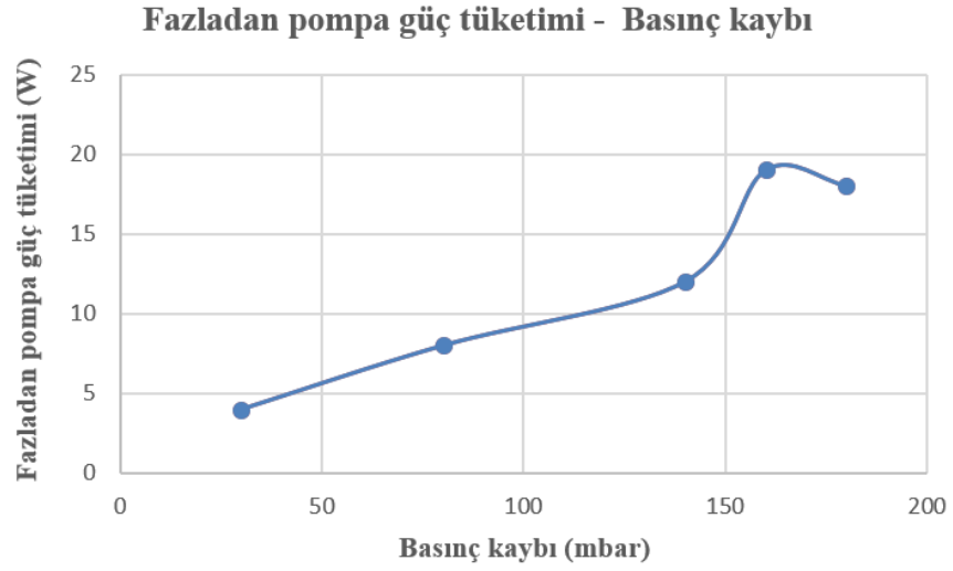
Şekil 2.6 Birikinti nedeniyle oluşan basınç kaybına karşı fazladan harcanan pompa gücü
