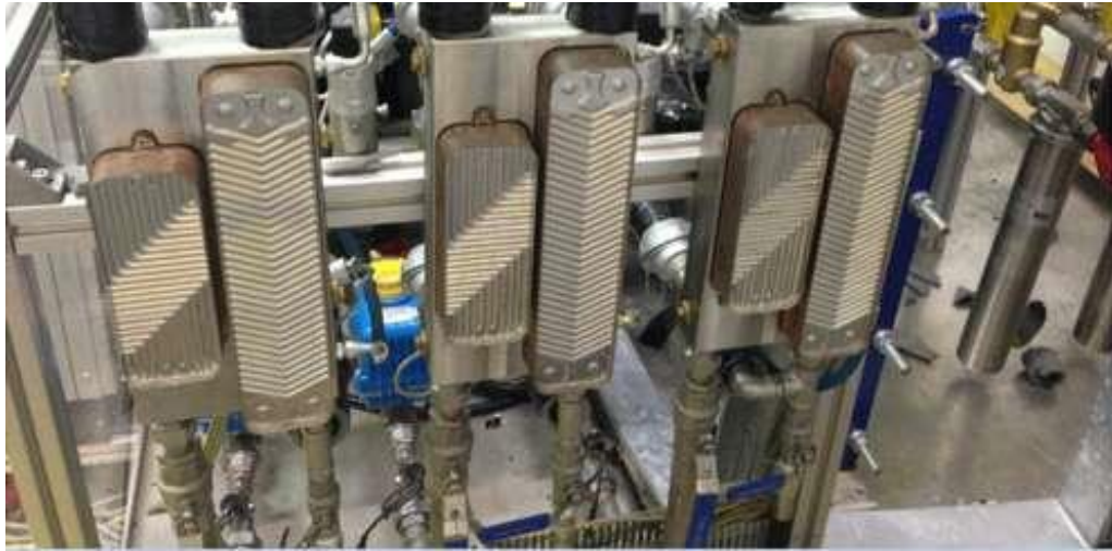
Şekil 6.20 Kireçlenme Deney Düzeneği ve Plakalı Isı Değiştiricisi Montaj Fotoğrafı
