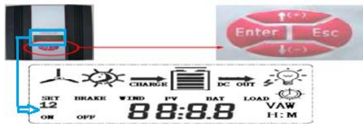
Şekil 3.9 Hibrit şarj kontrolörünün kumanda paneli ve LCD ekranı
