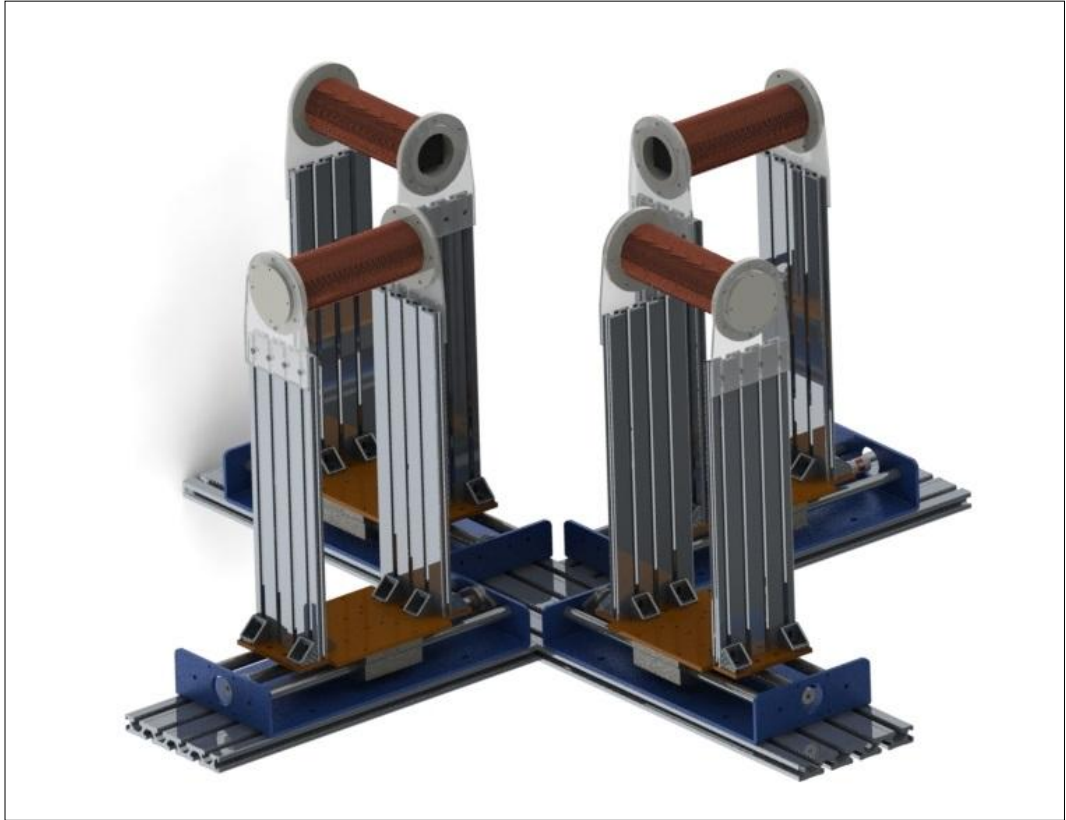
Şekil 3.4 Hareketli elektromanyetik kutupların ana şasiye montajı
