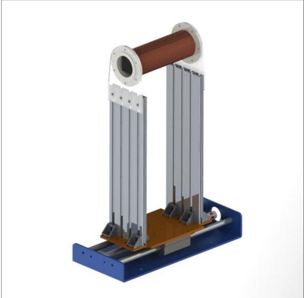
Şekil 3.3 Elektromanyetik kutupların doğrusal hareket sistemlerine entegre edilmesi
