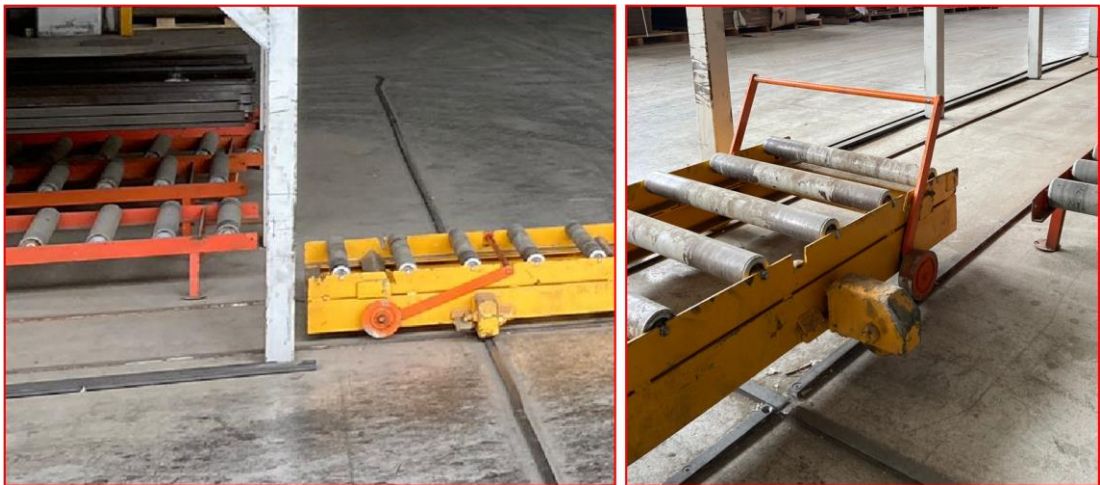
Şekil 4.37 : Hareketli konveyör yatay hareket mekanizması
