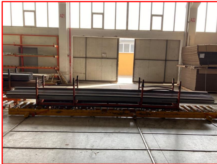
Şekil 4.33 : Metal hat deposu yeni profil taşıma konveyör hattı.
