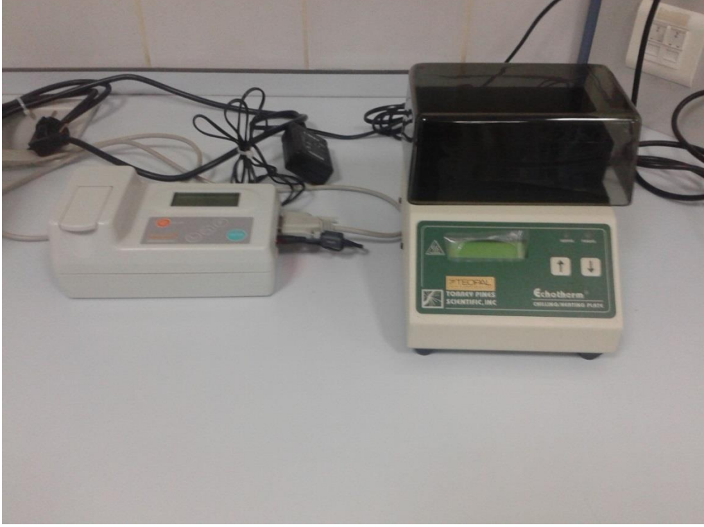
Şekil 3.4: Microtox® toksisite deneylerinde kullanılmış olan inkübatör ve lüminesans okuyucusu
