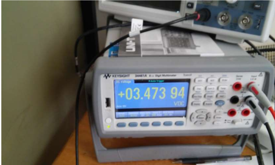
Resim 4.10. Yük çıkışının sayısal multimetre çıkışından gözlenmesi
