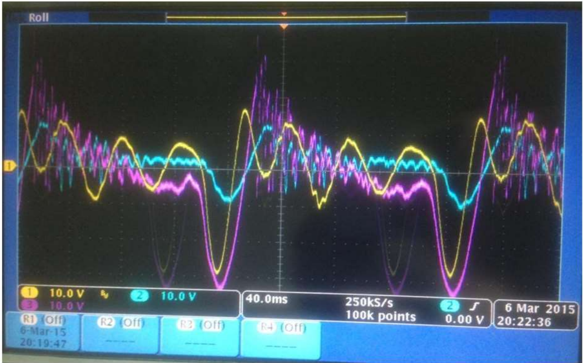
Şekil 4.10. Rüzgar tüneli denemelerinde üç piezoelektrik levhadan alınan gerilimler: Her birinden V_{pp}=60V , V_{pp}=48 V ve V_{pp}= 22 V maksimum değerlerine ulaşan dalga formları elde edilmiştir (Rüzgar hızı u= 3.4 \text{ m/s} )
