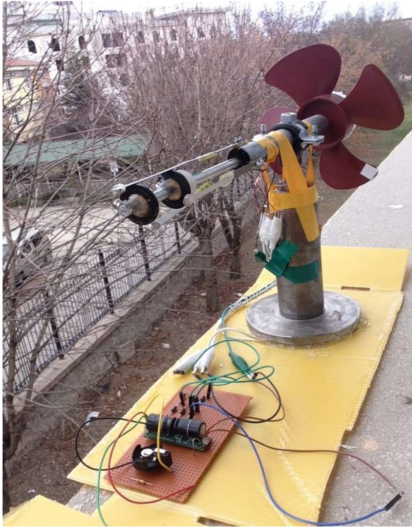
Resim 4.12. Sistemin saha şartlarında test edilmesi (Ticari üreteç devresi ile doğrultucu devre ile)
