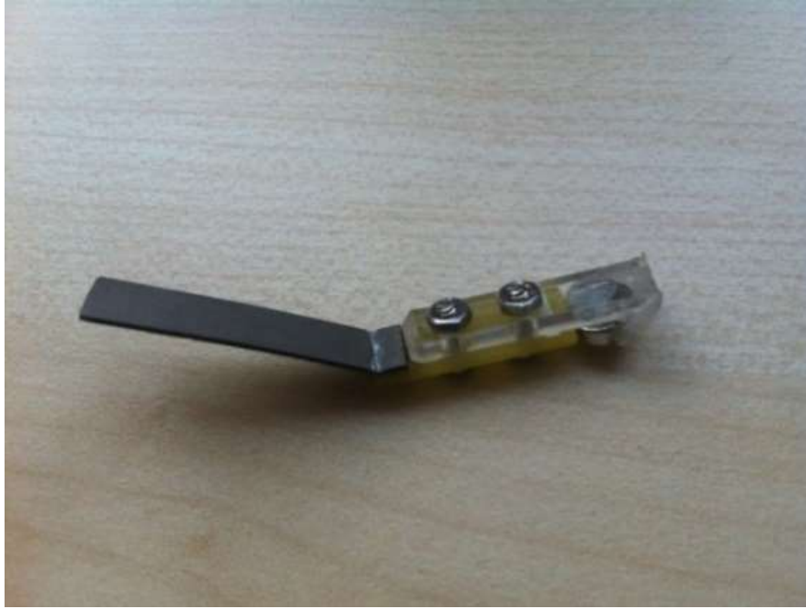
Resim 4.13. Rüzgâr hızının 3.4 m/s'den büyük olduğunda piezoelektrik levhada oluşan kırılma
