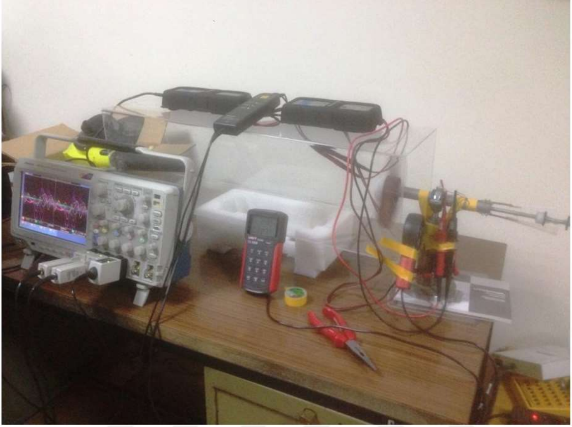
Resim 4.4. Temassız piezoelektrik rüzgar enerjisi üreticinin rüzgar tüneli testi
