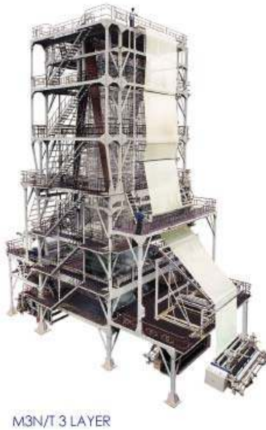
Şekil 2.10 3 Layer bir ekstruderde kule [19].
