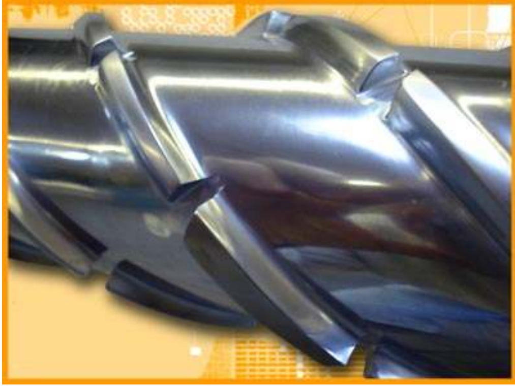
Şekil 2.6 Ekstruder vidası profili [18].
