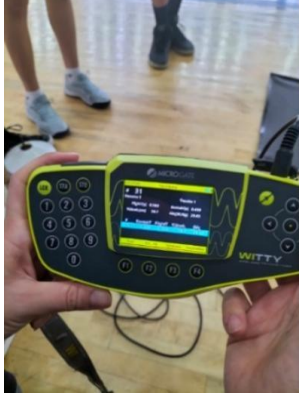
Şekil 9. Dikey Sıçrama Ölçüm Aleti (Microgate Witty Photocell)
