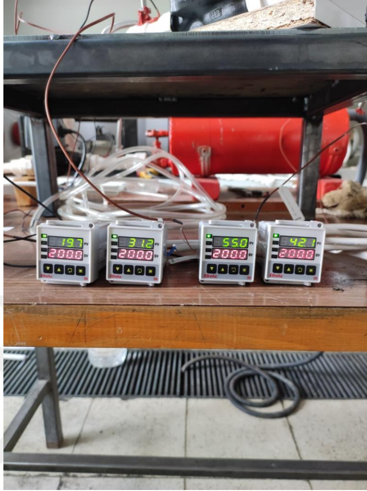
Şekil 4. 6: Akışkanların giriş ve çıkış sıcaklıklarının okunması
