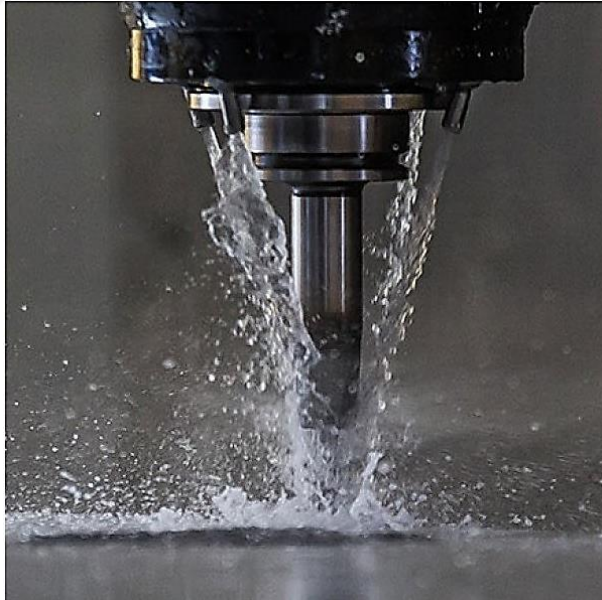
Şekil 3. 13: Talaşlı imalat yönteminde soğutma sıvısı
