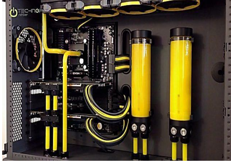
Şekil 3. 14: Elektronik sistemlerde sıvı soğutma sistemi
