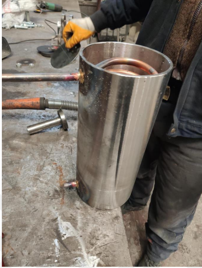
Şekil 4. 15: Bakır boru çıkışlarının sızdırmazlık için kaynatılması
