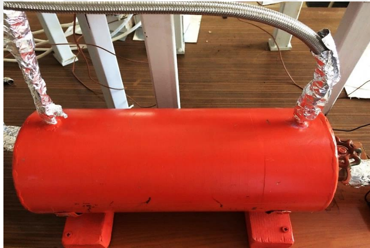
Şekil 4. 18: Isı deęiřřiricisi montaj hali
