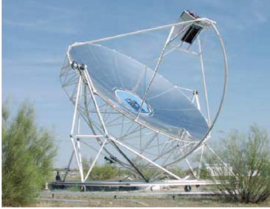
Resim 2.3. Parabolik ayna/ısı-motoru sistemi [60]
