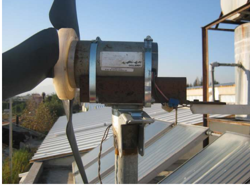
Şekil 3.13. Hız dönüştürücü olmadan kanatların bağlantısı
