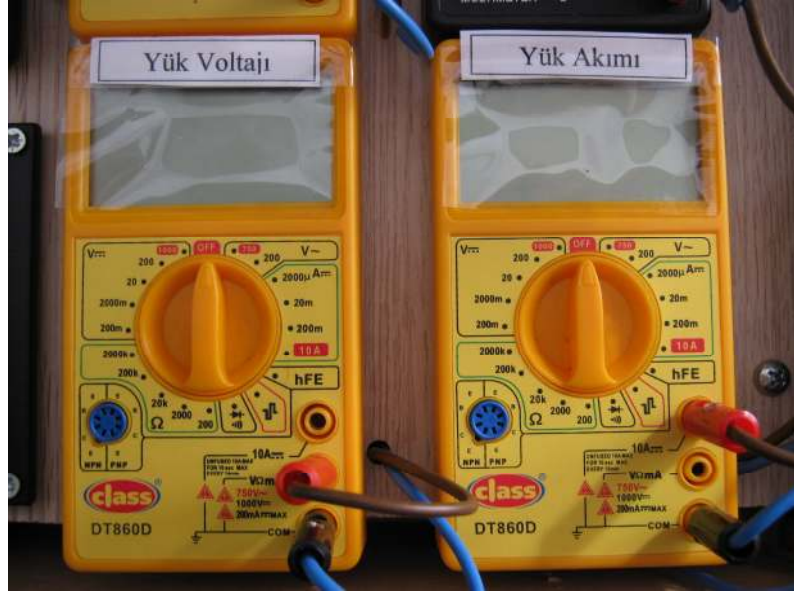
Şekil 3.23. Multimetre (Volt ve Amper ölçer)
