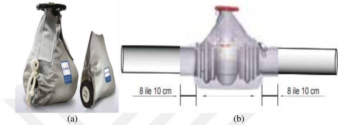
Şekil 3.2. (a) Vana ceketi görseli (URL-3) ve (b)doğru uygulanmış bir vana ceketi izolasyon uygulaması (URL-8).
