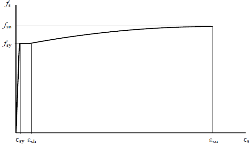
Şekil 3.3 : Donatı çeliğinin gerilme-şekildeğiştirme bağıntısı [8].
