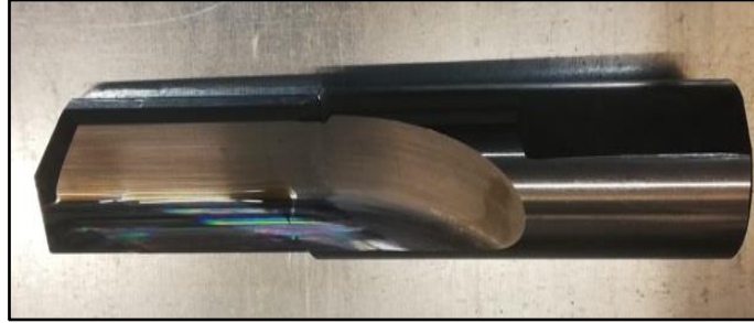
Şekil 74. Uygulama Yapılacak 90 HRC Sertliğinde Karbür Kesici Resmi
