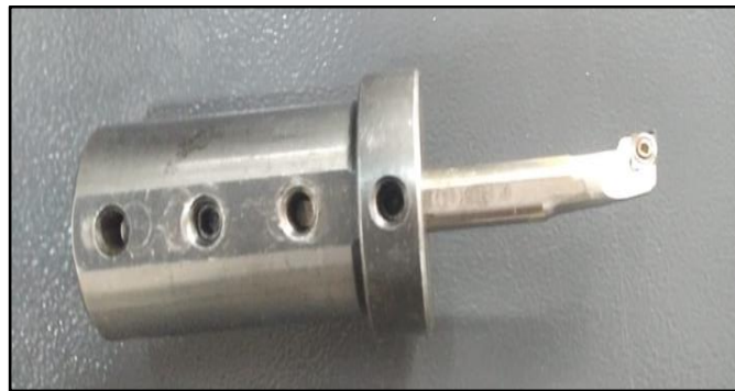
Şekil 75. Uygulama Yapılacak CCMT Sert Maden Plaket Takılmış Kater Resmi
