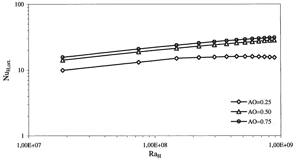
Şekil 5.104. \theta=0^\circ 'de ortalama Nusselt sayısının Rayleigh sayılarındaki değişimi (AO=0,25-0,50-0,75 ve GO=1, AK=Merkezden)
