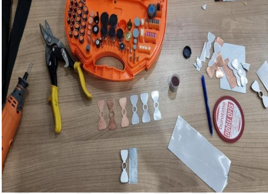
Şekil 2.20. Farklı malzemelerden üretilmiş türbülator kanatçıkları (Demiray, 2022)
