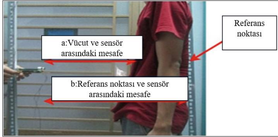
Resim 2.1 Sensör kullanarak boyut genişliği tahmini (Ly vd. 2018).
