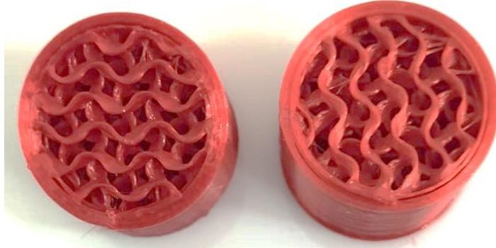
Şekil 3.6. 3D yazıcıda üretilen kemik modellerinin iç yapısı.
