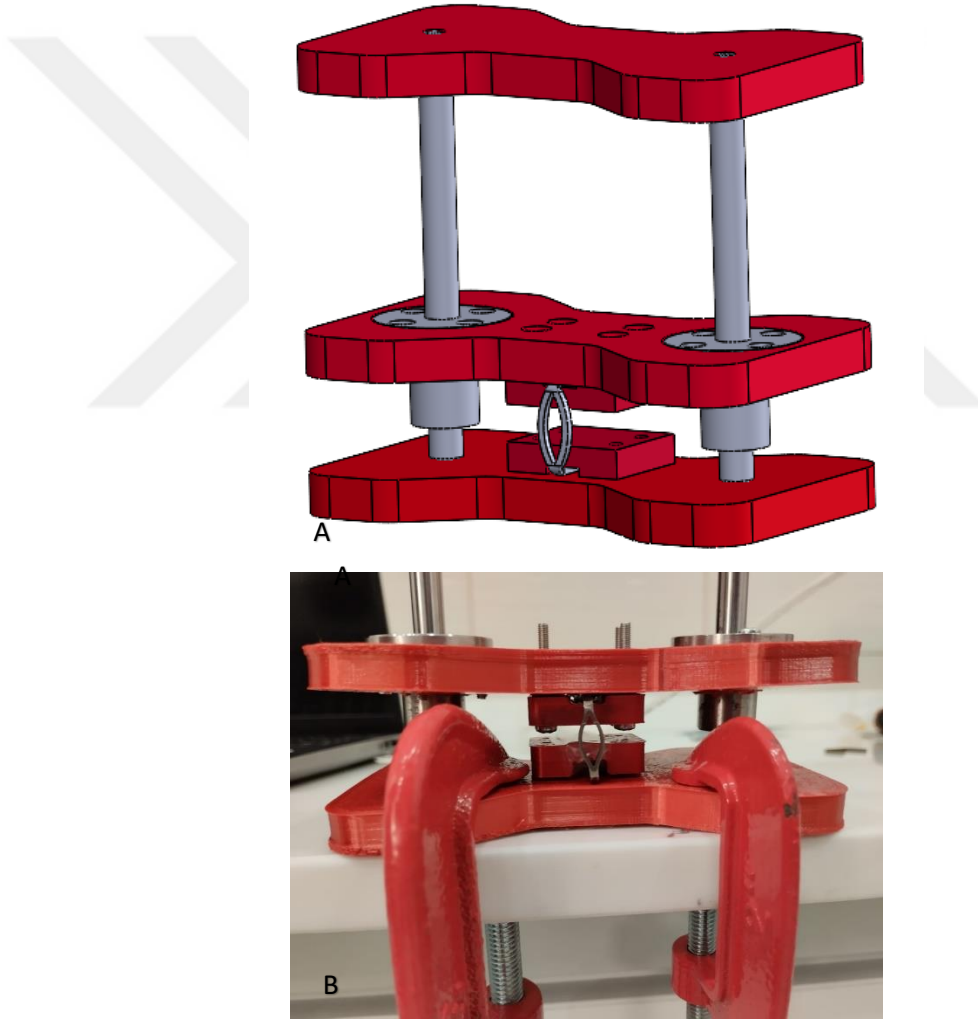
Şekil 3.16. Staplerin kuvvet ölçümünde kullanılan deney düzeneği A: solidWorks montajı B: deney düzeneği gerçek montajı.
