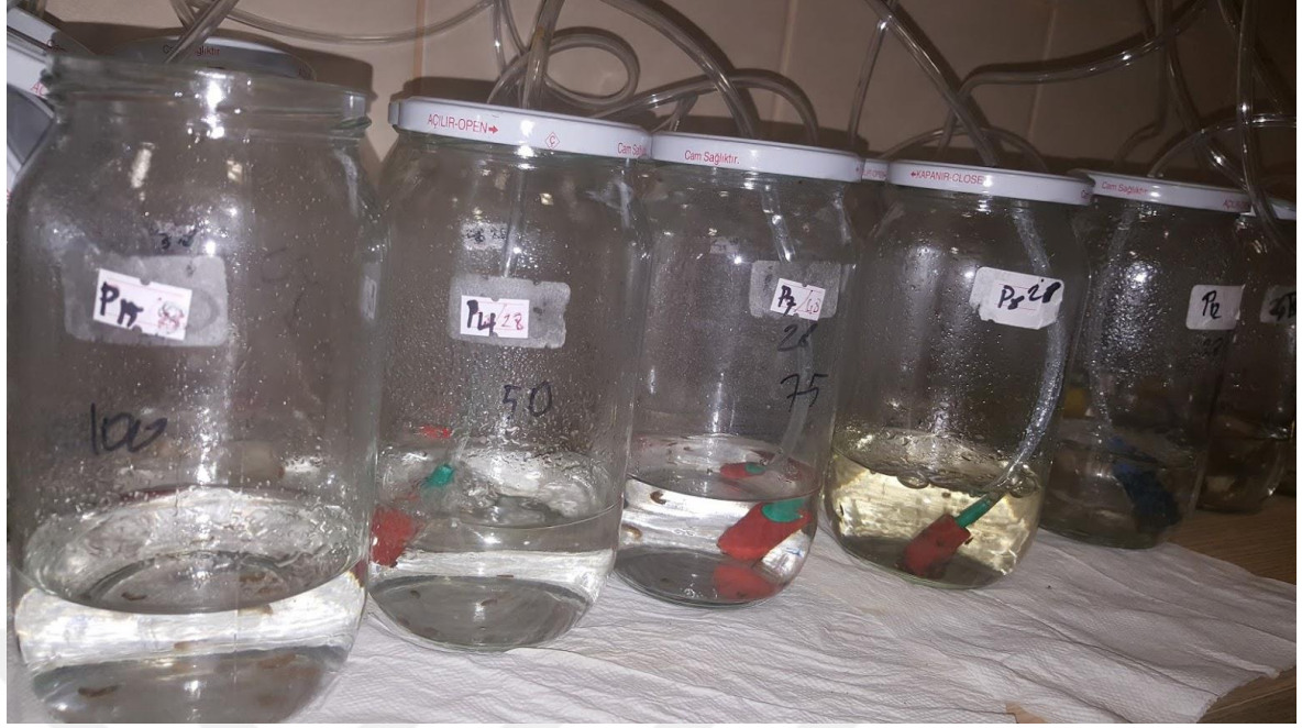
Resim 2.2. Akvaryumlara yeterli hava akımını sağlayan hava motorları bağlanarak G. pulex örnekleri için gerekli oksijen akımının verilmesi
