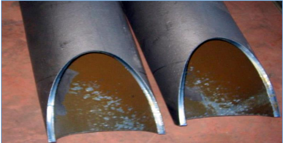
Şekil 5.26. Boruya kurtağzı açılmış görünüş (URL-31).
