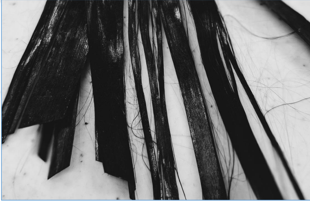
Şekil 5.36. Karbon fiber tel ve demetler (URL-44).
