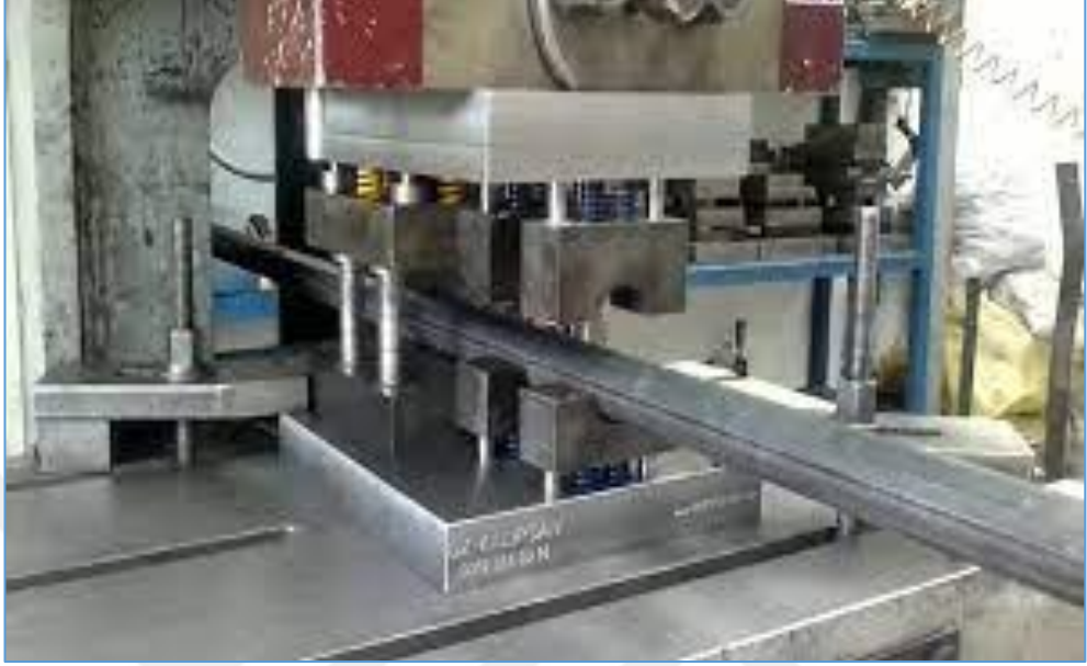
Şekil 5.25. Boru kalıplama (URL-30).
