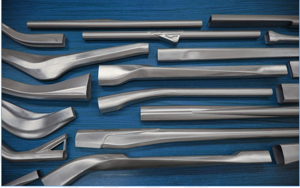
Şekil 5.33. Alüminyumdan kadroda kullanılan hidroformlu borular (URL-38).
