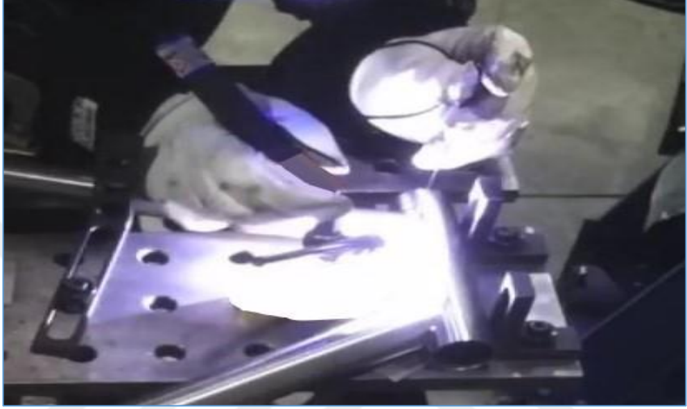
Şekil 5.49. Kaynak punta işlemi (İmalat Süreci).
