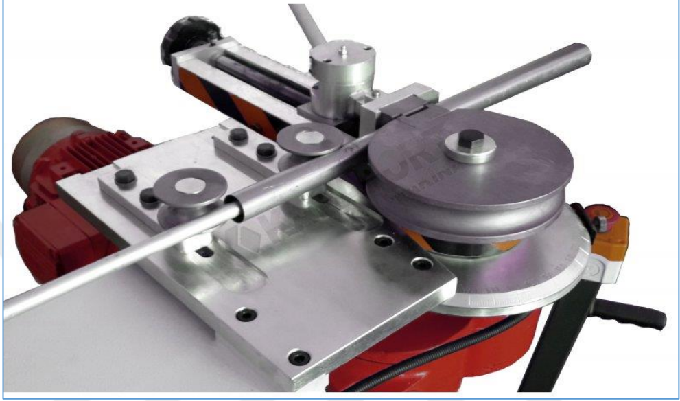
Şekil 5.31. Boru bükme makinesi (URL-36).
