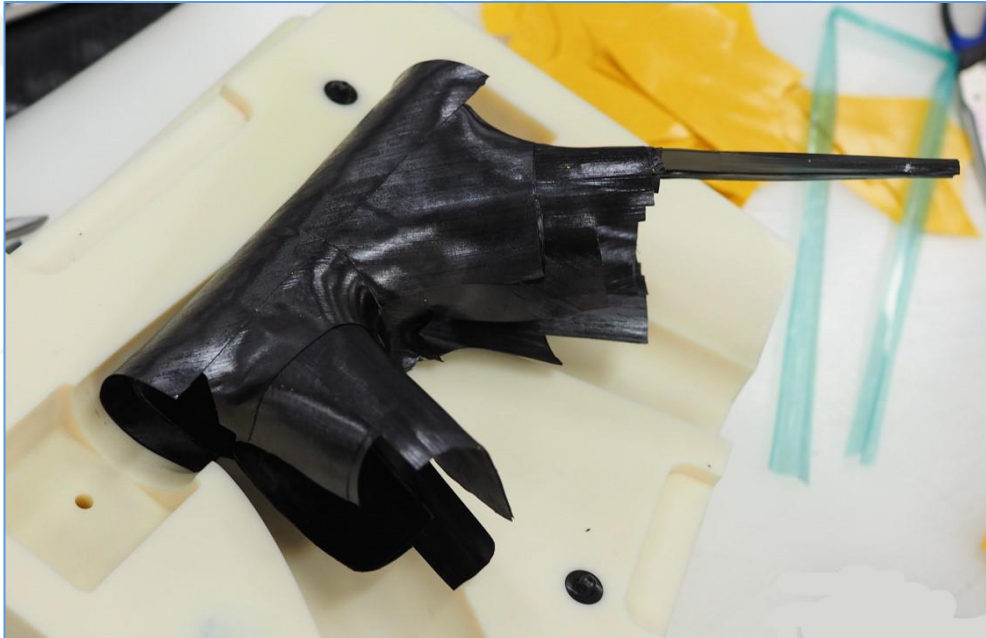
Şekil 5.38. Karbon fiber sarılmış kadro ön borusu (URL-46).
