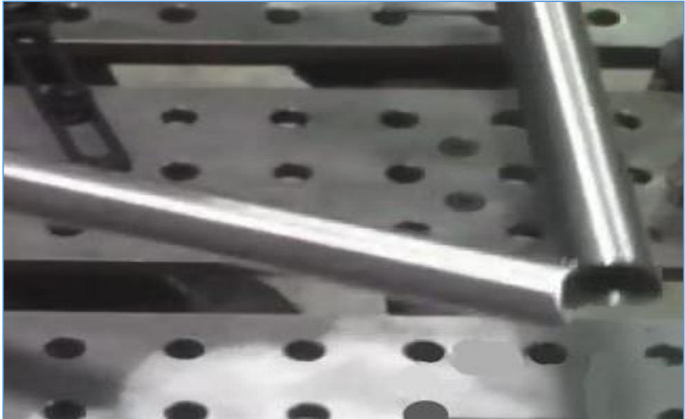
Şekil 5.46. Birleşim yerlerine kurt ağzı açılmış malzeme (İmalat Süreci).
