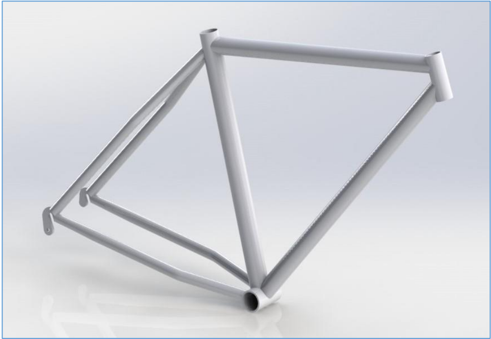
Şekil 5.21. Kadro kulakları ilavesiyle montajın tamamlanmış hali (İmalat Süreci).
