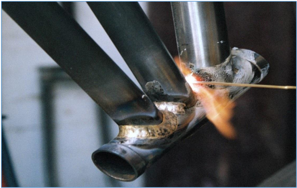
Şekil 5.42. Lehimleme ile kadro parçaları birleştirme (İmalat Süreci).
