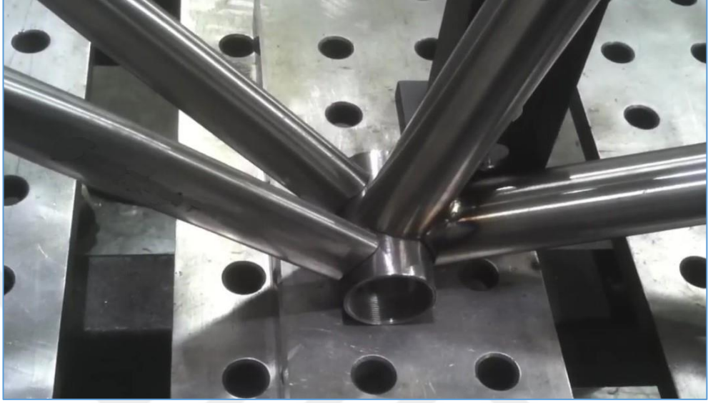
Şekil 5.51. Orta göbek borusu bağlantıları (İmalat Süreci).
