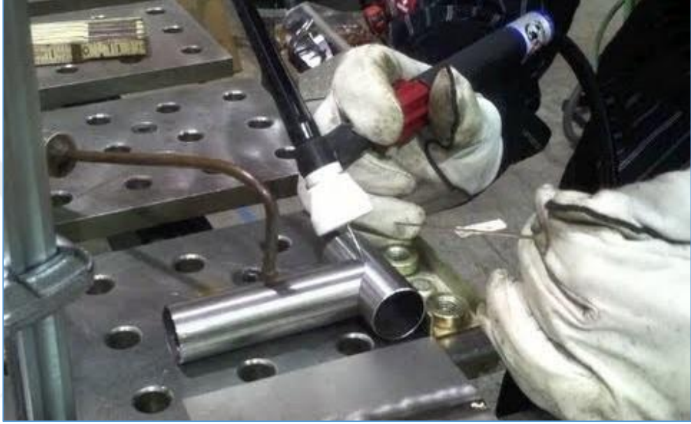
Şekil 5.41. TIG kaynağı ile kadro parçaları birleştirme (URL-49).
