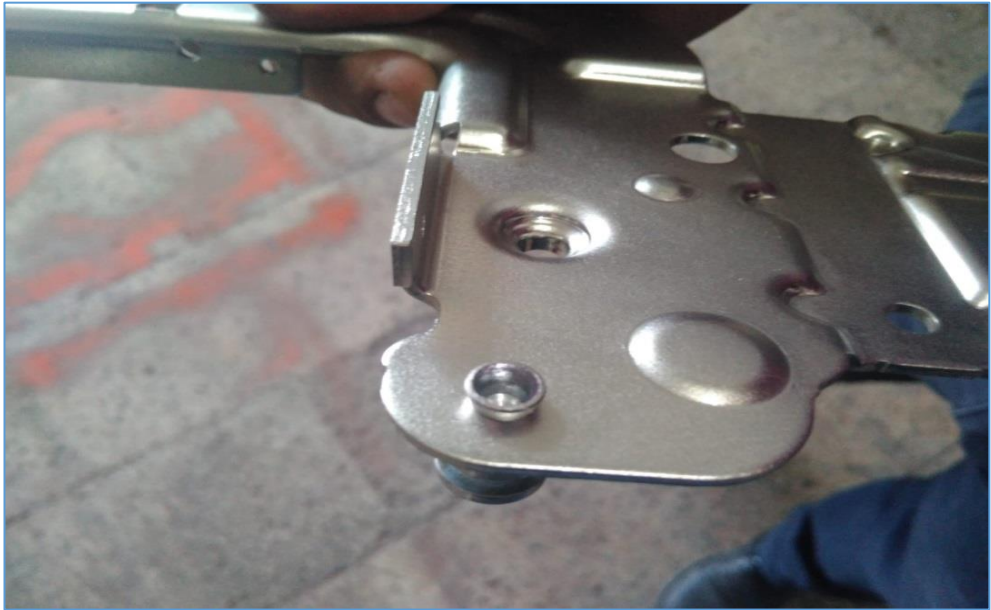
Şekil 5.28. Kalıpla form verilmiş sac (URL-33).
