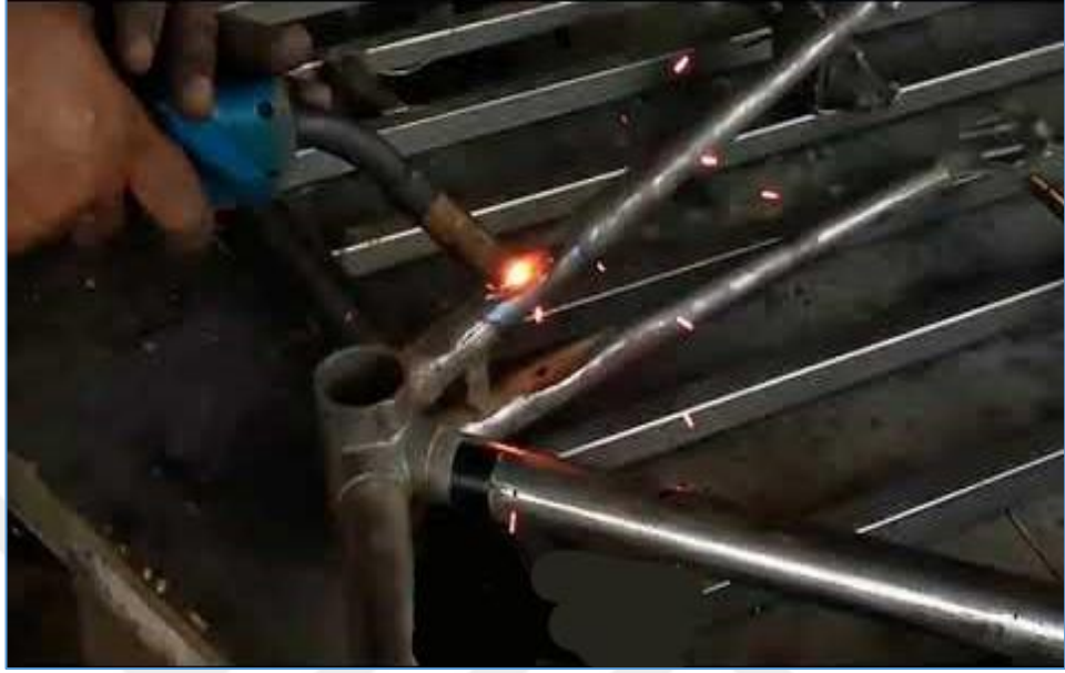
Şekil 5.40. MIG kaynağı ile kadro parçaları birleştirme (URL-48).
