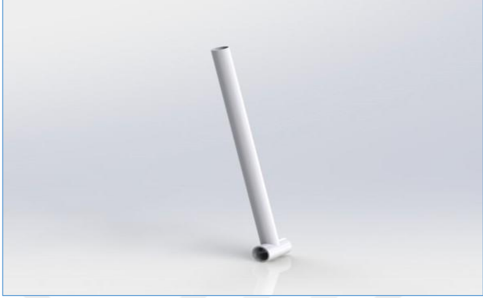
Şekil 5.18. Orta göbek borusu ve koltuk borusu gösterimi (İmalat Süreci).
