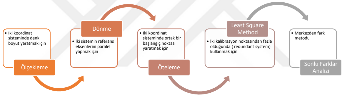
Şekil 6.4. Conformal Transformation Adımları.
