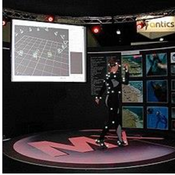
Şekil 3.2. Pasif marker takılı hareket yakalama için özel olarak tasarlanmış tam vücut spandeks / likra elbisesi [20].
