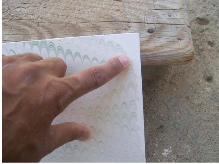
Fotoğraf 23 : Pişirim sonrası Taraklı Ebru Sırlı 960 °C
