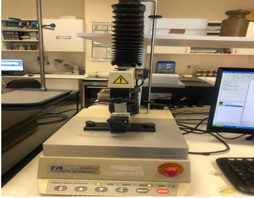
Şekil 3. 2. Germe testinde kullanılan çeneler fotoğrafı
