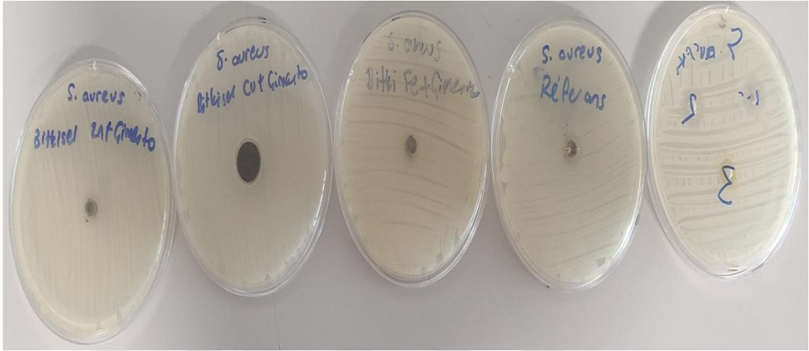
Şekil 4.11. Staph grubu bakterisi bulunan metal oksit katkılı harçlar
