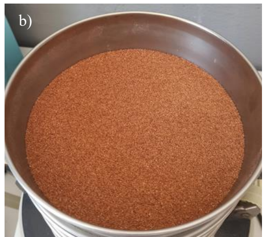
Şekil 4.4 : a) Elek sarsma cihazı b) Şeftali çekirdeği tozunun 425 mikronluk elekten geçirilmiş görüntüsü.
