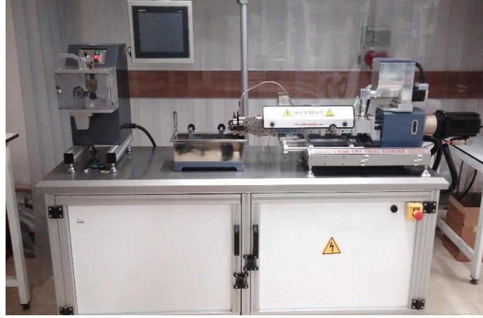
Şekil 4.7 : Gülner makina çift vidalı ekstrüder.
