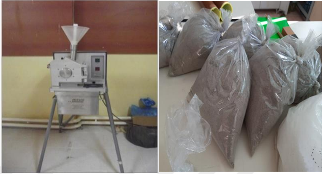
Şekil 10. Wiley değirmeni ve un haline gelmiş atık gazete kağıdı
