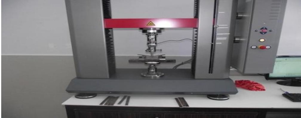
Şekil 12. Zwick/Roell Z050 Üniversal Test Makinesi
