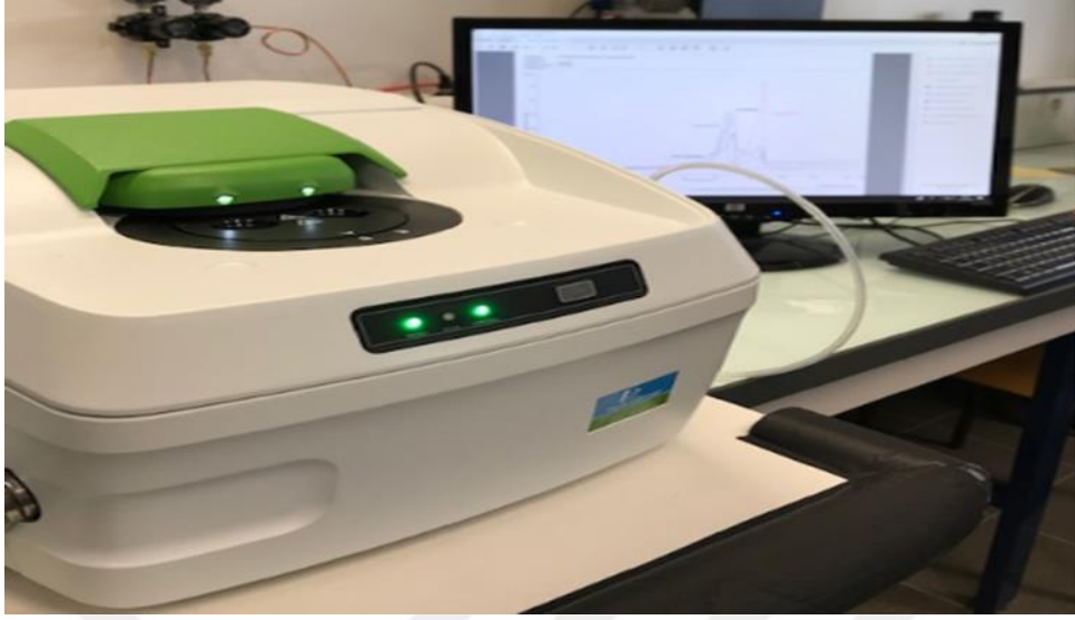
Şekil 15. Diferansiyel Taramalı Kalorimetre (DSC) Cihazı
