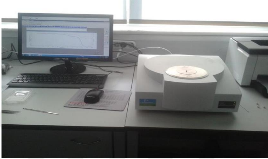
Şekil 14. Termogravimetrik analiz (TGA) Cihazı
