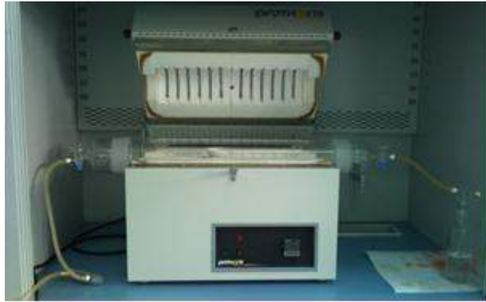
Şekil 5. 4 Split tipi boru fırın reaktör
