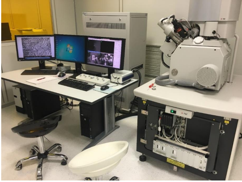
Şekil 3-12: Taramalı Elektron Mikroskobu (SEM, FEI Versa 3D, USA)
