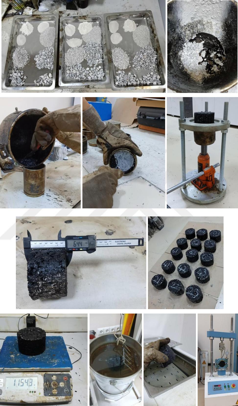
Şekil 3.28. Marshall Tasarım Deneyi Aşamaları
