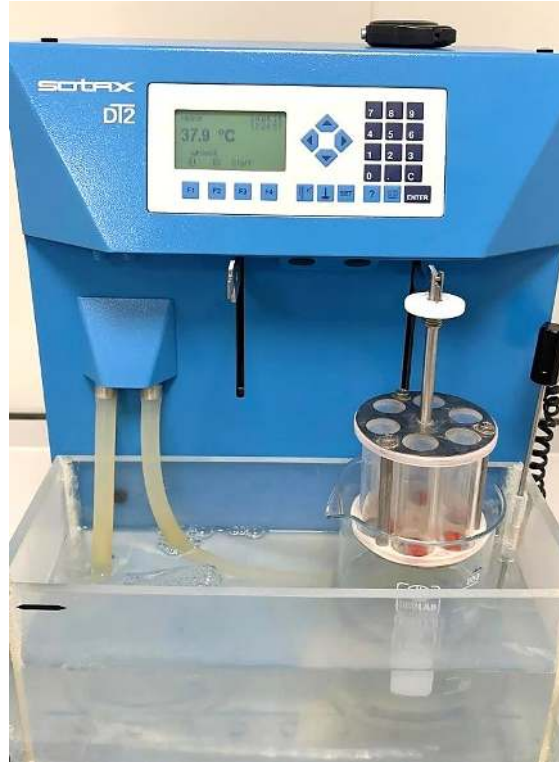
Şekil 2.7. Yumuşak tablet formunun dağılma cihazında gerçekleştirilen karakterizasyon analizi
