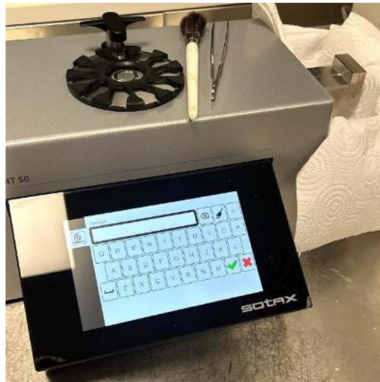
Şekil 2.9. Yumuşak tablet formunun sertlik cihazında gerçekleştirilen karakterizasyon analizi
