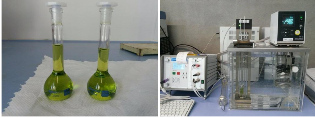
Şekil 2.8 Viskozite ölçümü ile polimerizasyon derecesinin hesaplanması
