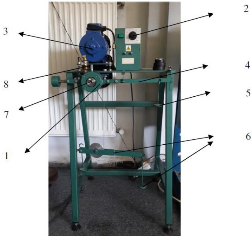
Şekil 2.2. Deney tertibatı elemanlarına ait detaylar; Yatak burcu (1), Elektronik takometre (2), Hız kontrol sistemiyle hızı değiştirilebilir elektrik motoru (3), Moment kolu (4), Denge ağırlıkları askısı (5), Yük kolu ve askısı (6), 40 mm çaplı çelik mıyılı (7) ve içine termokupl ucu yerleştirilen vida (8).
