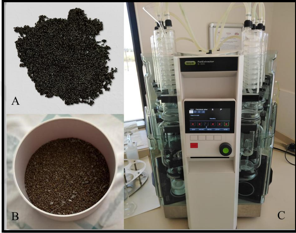
Şekil 3.3 Kivi çekirdeklerinin yağ asitleri tayini, A) Kivi çekirdeklerinin meyveden ayrılması, B) Kurutulmuş kivi çekirdekleri, C) Soxhlet cihazı ve kivi çekirdeklerinin ekstraksiyonu
