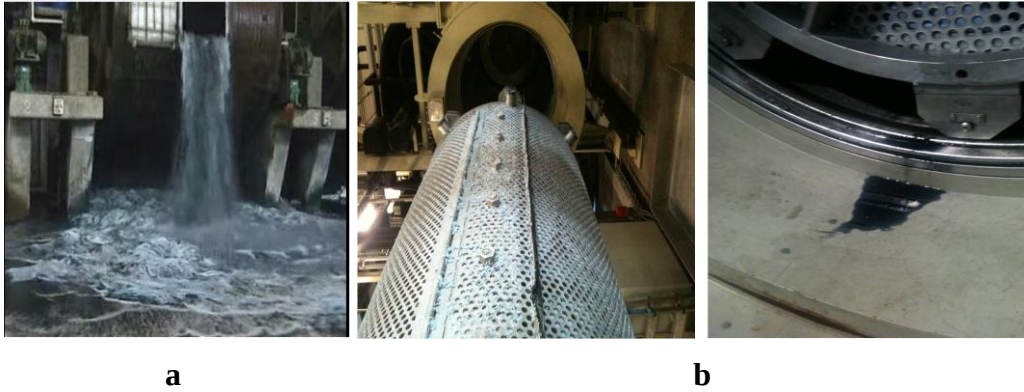
Şekil 3.7. Geleneksel (a) ve süperkritik ortamdaki (b) krom tabaklama prosesleri sonrasında ortaya çıkan atık su yükleri
