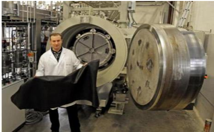
Şekil 5.23. Sanayi ölçekli (1700 L) yüksek basınç tabaklama otoklavı
