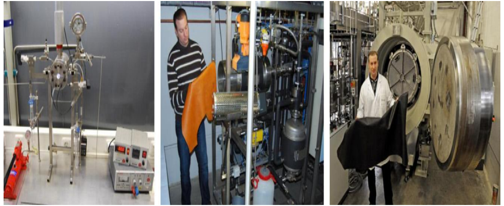
Şekil 3.3. Laboratuvar (sol), 20 L pilot (orta) ve 1700 L sanayi ölçekli (sağ) yüksek basınç cihazları
