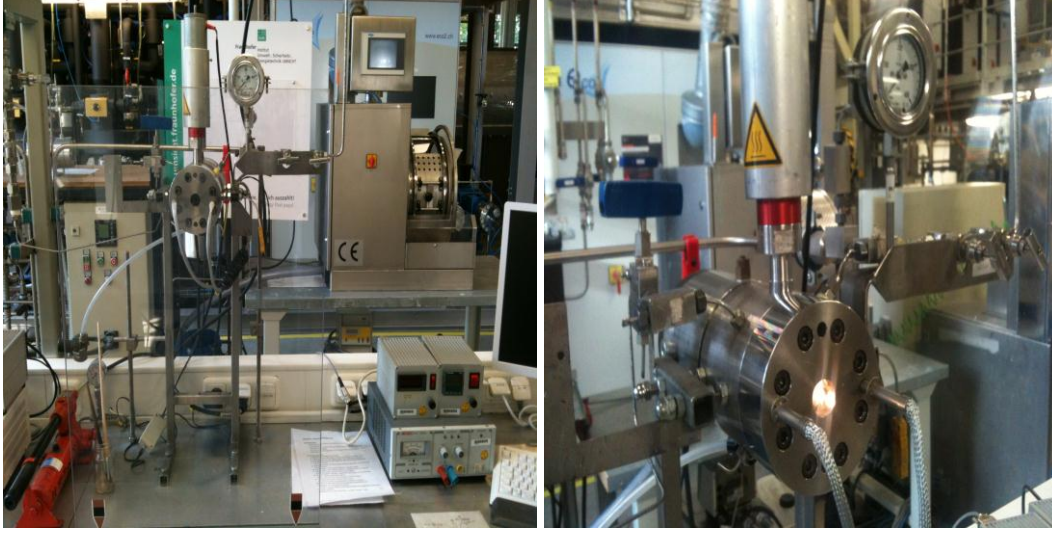
Şekil 4.10. 63 mL işlem kapasitesine sahip yüksek basınç hücresi
