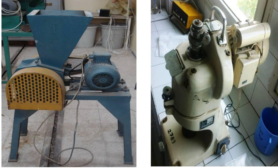
Şekil 4.1. Yem öğütme makinası ve Bühler-Miag değirmeni
