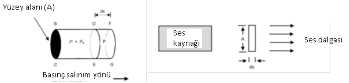
Şekil 2.13 Ultrason probundan çıkan ses dalgalarının şematik gösterimi (Mason and Lorimer, 2002)
