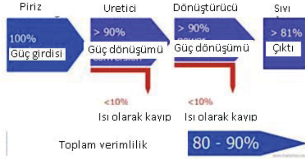
Şekil 2.10 Tipik bir ultrason sisteminde enerji kayıpları (Mason and Tiehm, 2001)
