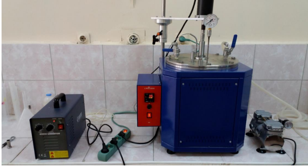
Şekil 4.6. Sıcaklık, basınç ve karıştırma hızı kontrol edilebilen reaktör
