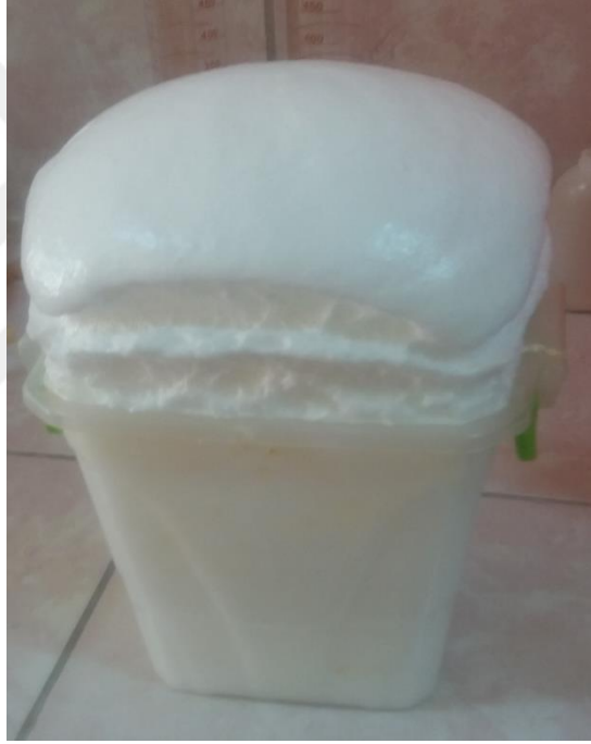
Şekil 4.4. Kanola yağından elde edilen poliol ile poliüretan esnek sünger üretimi
