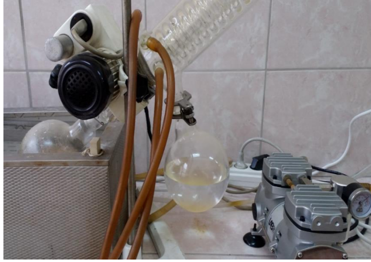
Şekil 4.3. Safsızlıkların vakumlu döner buharlaştırıcı ile uzaklaştırılması
