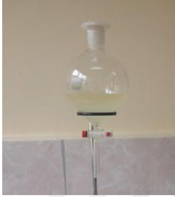
Şekil 4.2. Epoksillenmiş bitkisel yağın ayırma hunisi ile fazlarına ayrılması
