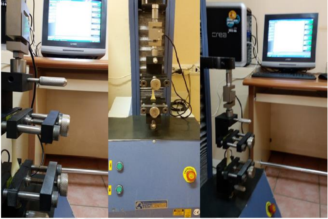
Şekil 5.54. Bitkisel yağ bazlı poliüretan standart numunelerin çekme testi ölçümleri
