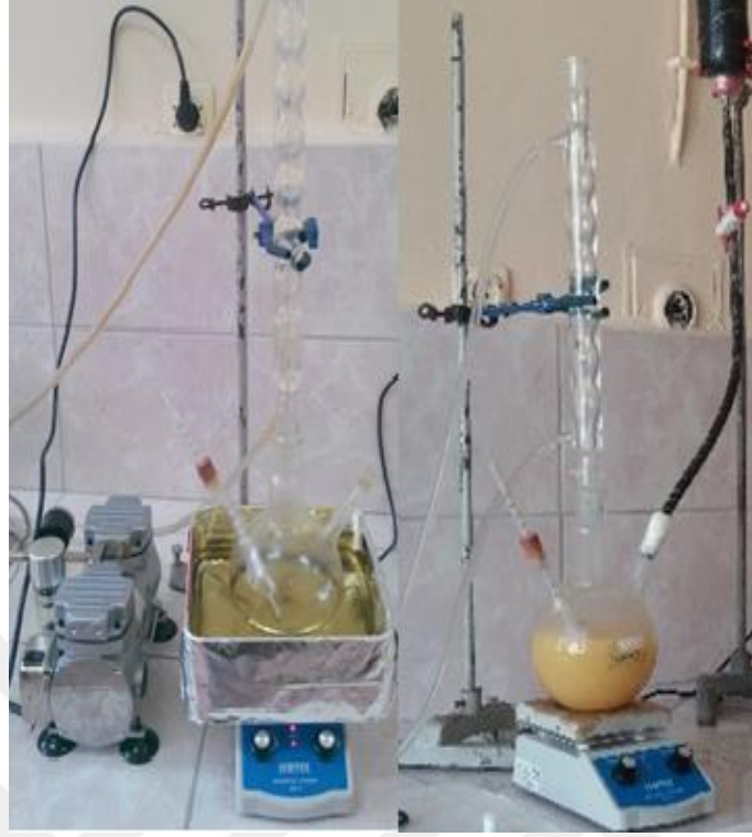
Şekil 4.1. Bitkisel yağların epoksilleme basamağı
