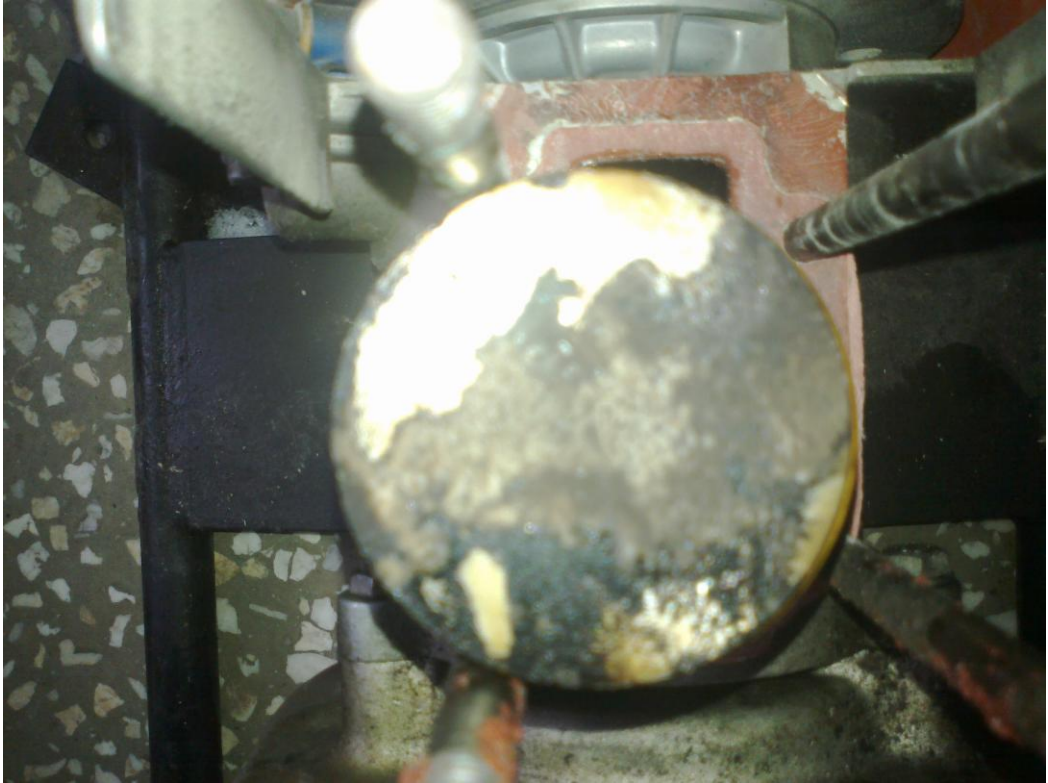
Şekil 5.1. Deney motorunun benzin-mineral yağ karışımı ile çalıştırılması sonucu pistonun üstten görüntüsü.
