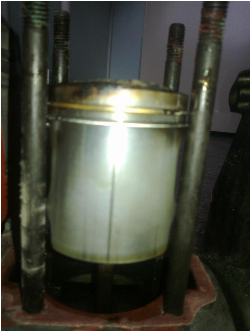
Şekil 5.2. Deney motorunun benzin-mineral yağ karışımı ile çalıştırılması sonucu pistonun yandan görüntüsü
