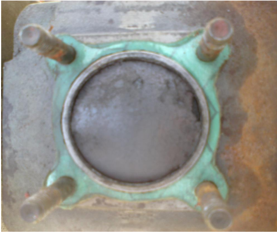
Şekil 5.3. Deney motorunun benzin-ayçiçek yağı karışımı ile çalıştırılması sonucu pistonun üstten görüntüsü
