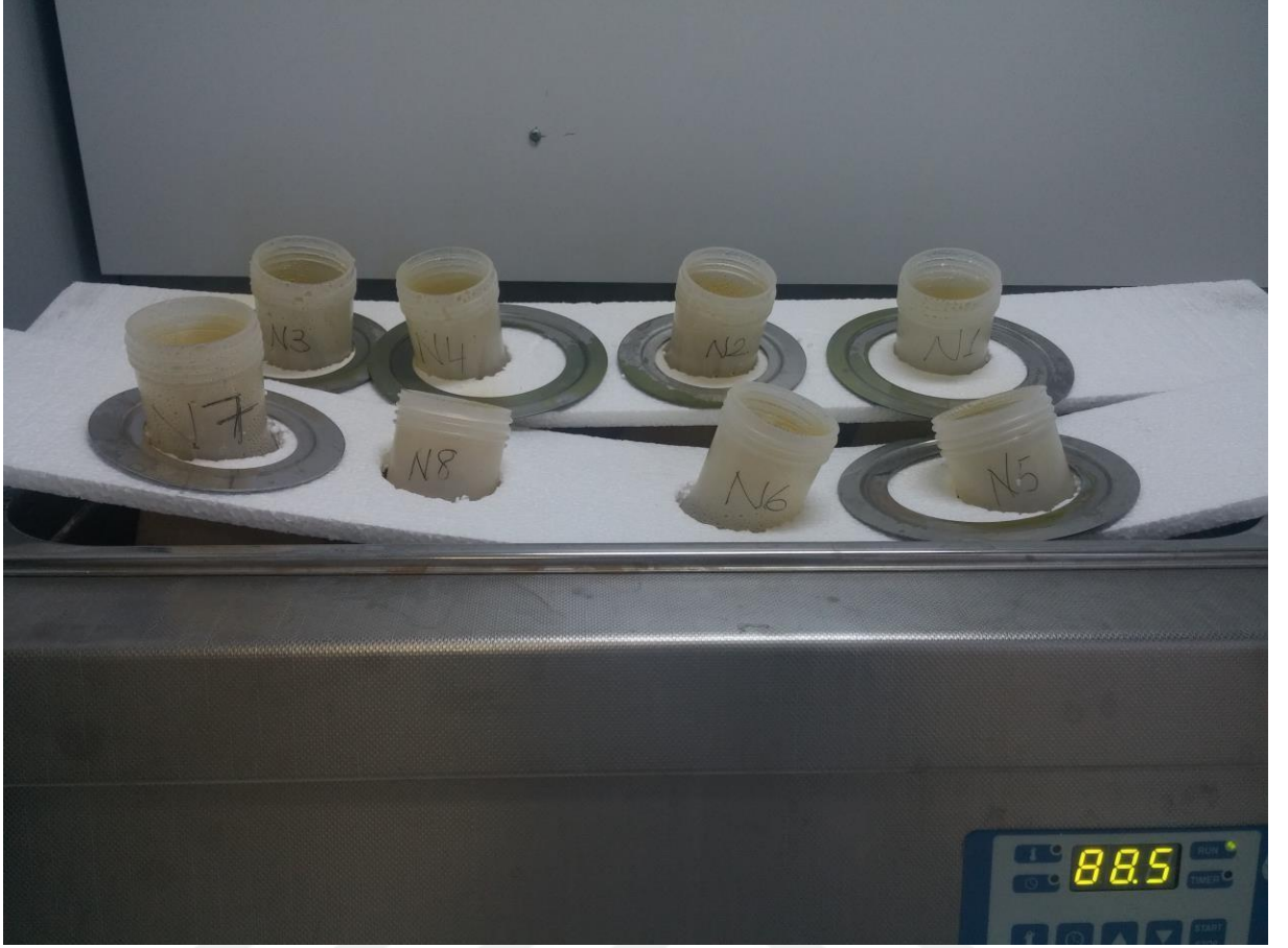
Şekil 2.20. Toprak Örneklerinde Buharlaştırma İşleminin Yapılması
