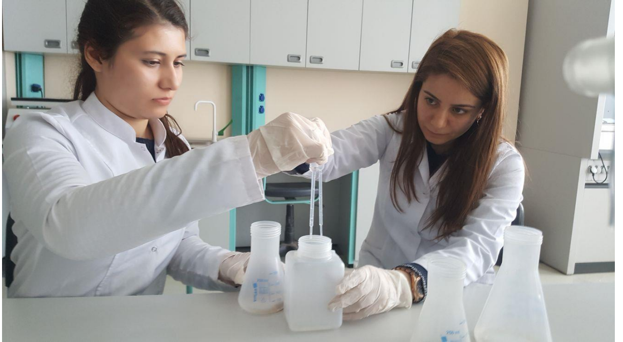
Şekil 2.21. Toprak örneklerine \text{HF} + \text{HNO}_3 ve \text{HCl} eklenmesi
