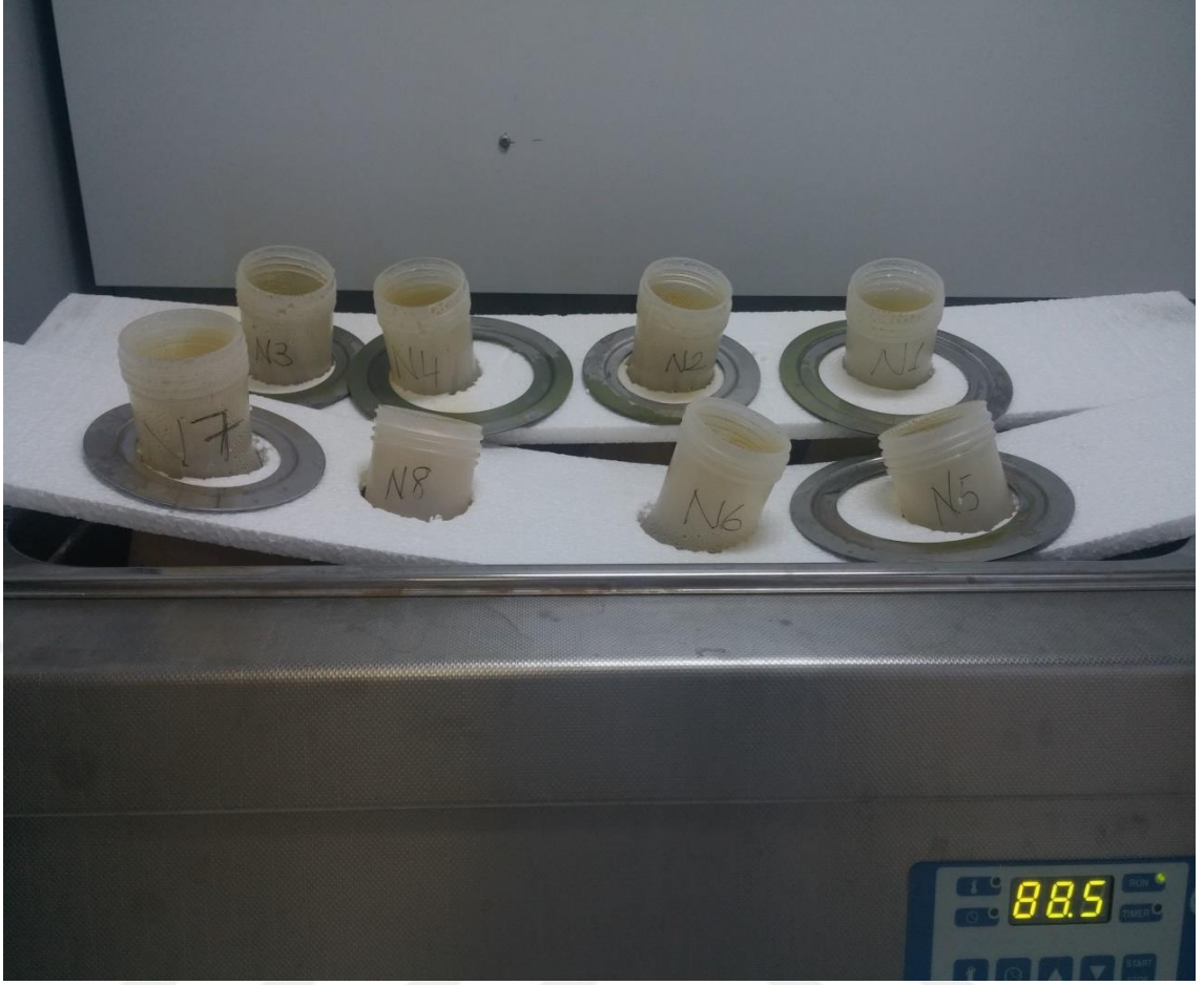
Şekil 2.10. Numunelerin su banyosuna yerleştirilmesi
