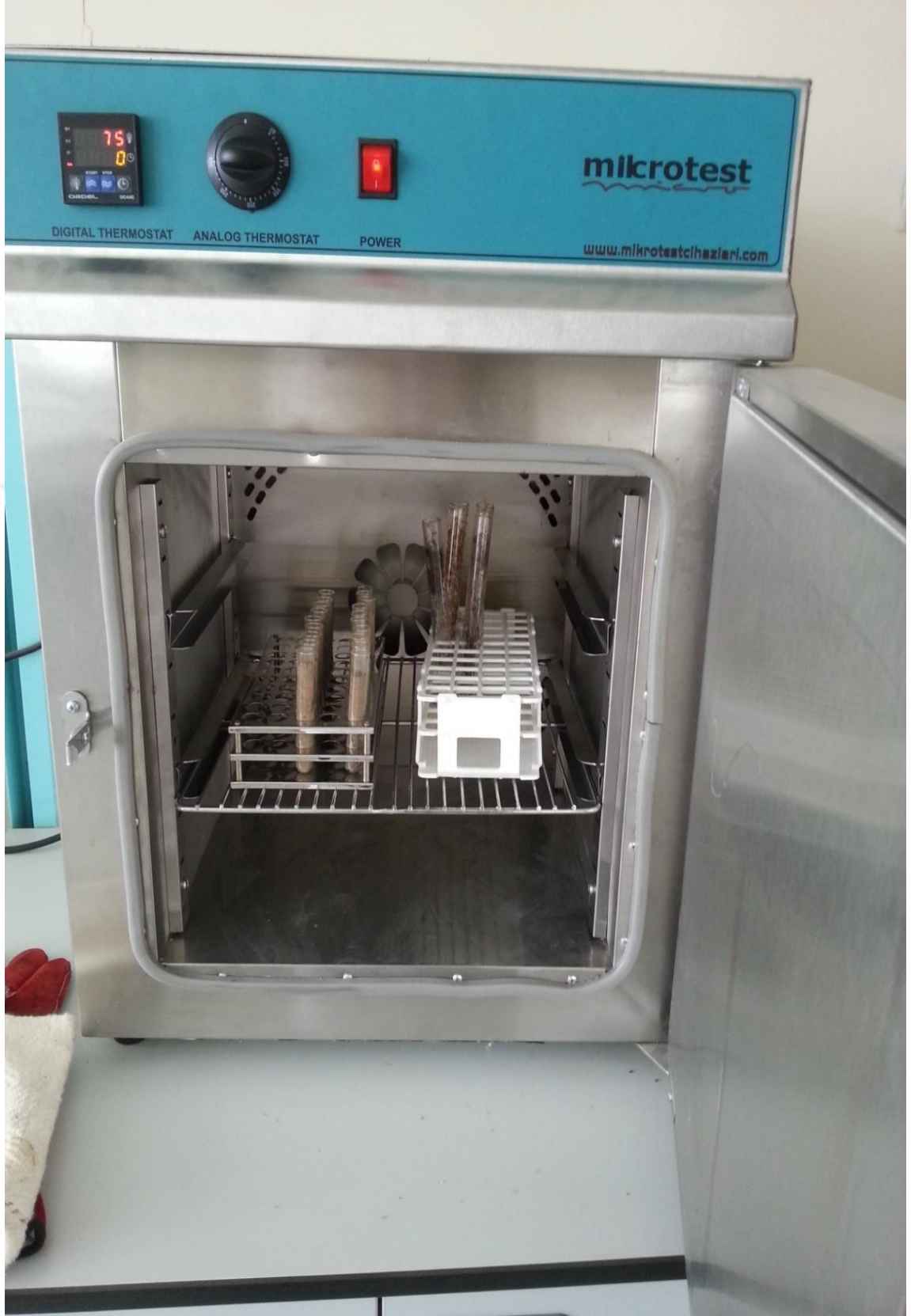
Şekil 2.6. Etüve alınan toprak örnekleri
