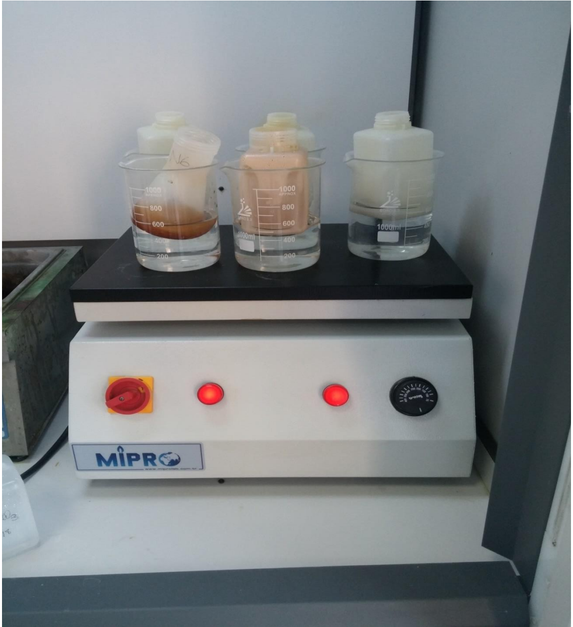
Şekil 2.14. Isıtıcı üzerinde buharlaştırılan numuneler
