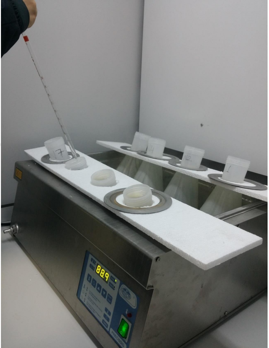
Şekil 2.11. Toprak eritme işlemini gerçekleştirirken azalan numunelere asit ilavesi
