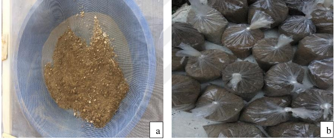
Şekil 2.1. Toprakların iki mm'lik elekten geçirilmesi (a), poşetlenen toprak örnekleri (b)
