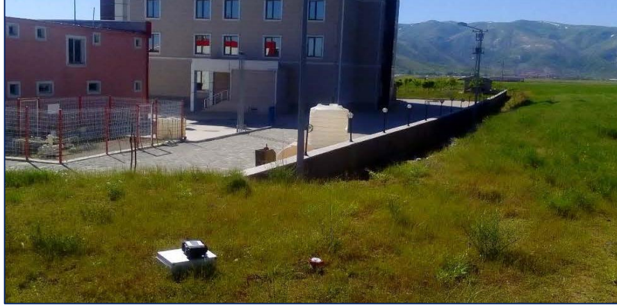
Şekil 4.13. İnceleme alanında mikrotremör ölçümlerinden görüntüler
