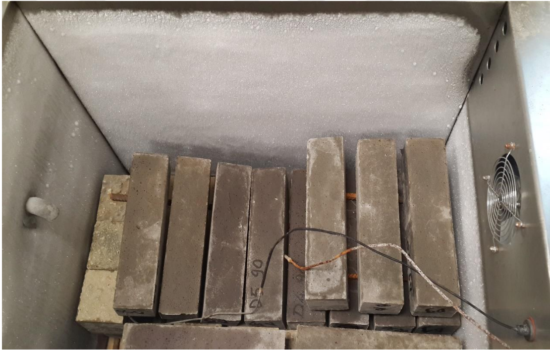
Şekil 3.4. Donma-çözünme deneyinde kullanılan deney aleti ve numune örneği
