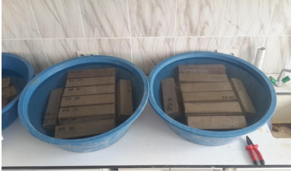
Şekil 3.5. Asit dayanıklılık deneyinde kullanılan numune örneği
