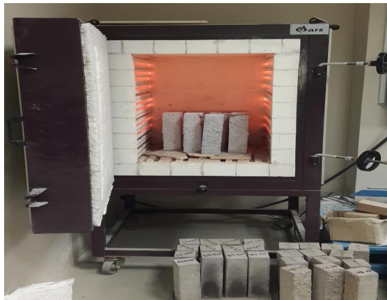
Şekil 3.3. Yüksek sıcaklık deneyinde kullanılan laboratuvar tipi fırın
