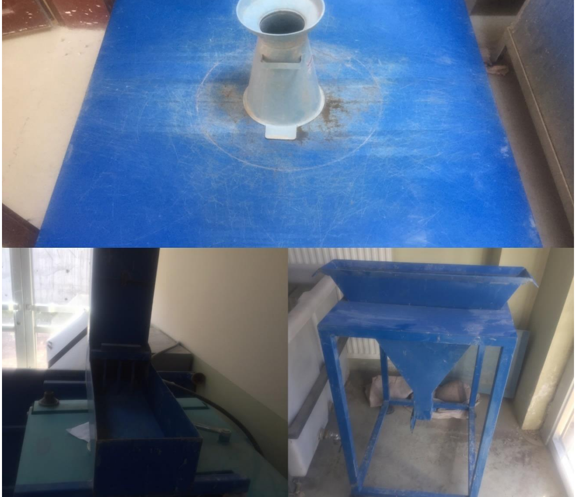
Şekil 3.1. Taze beton deneylerinde kullanılan aletler
