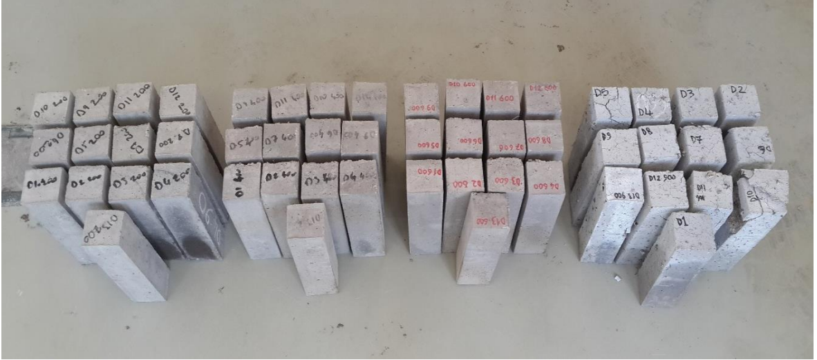
Şekil 4.10. KYFTHB'ların Yüksek sıcaklık deneyinden sonra numunelerde oluşan hasarlar
