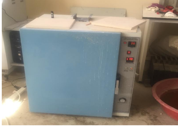
Şekil 3.6. Islanma-kuruma deneyinde kullanılan ayarlı fırın
