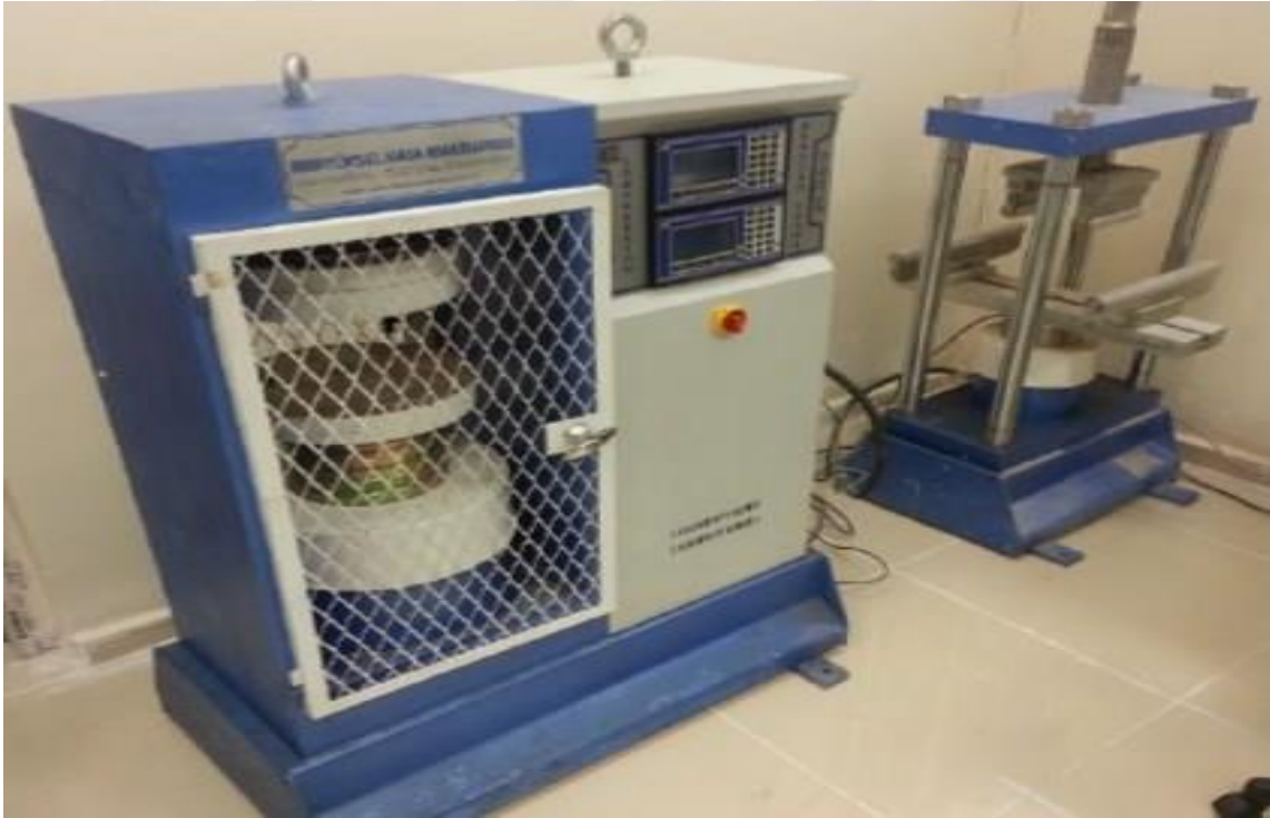
Şekil 3.2. Yük kontrollü eğilmede çekme deneyi ve basınç deneyi aletleri
