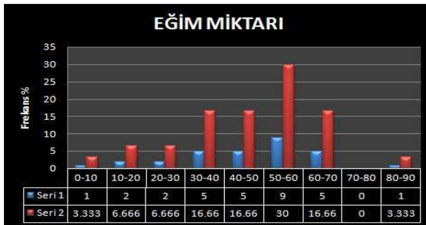
Şekil 4.47. Çırrık formasyonunda süreksizliklerin eğim miktarını gösteren histogram
