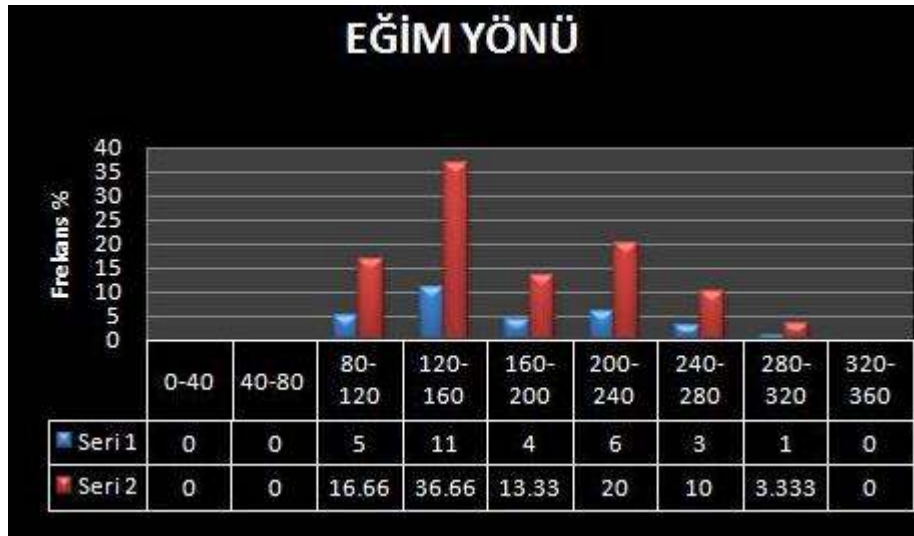
Şekil 4.71. Maden karmaşığında süreksizliklerin eğim miktarını gösteren histogram
