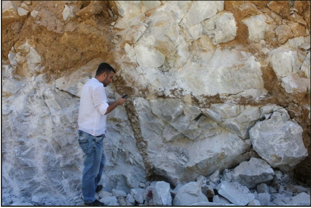
Şekil 4.6. Yol yarmasında gözlenen taze yüzeyli Çırık formasyonu kireçtaşları
