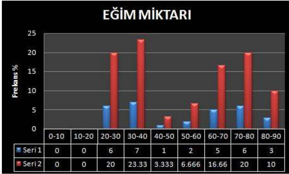
Şekil 4.36. Meydan formasyonunda süreksizliklerin eğim miktarını gösteren histogram
