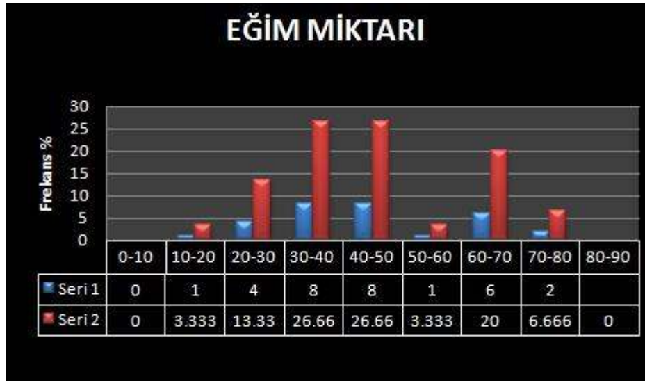
Şekil 4.71. Maden karmaşığında süreksizliklerin eğim miktarını gösteren histogram
