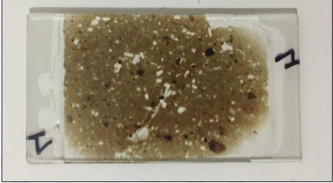
Şekil 3.5. Şerefiye Cami İnce Kesit Örneği
