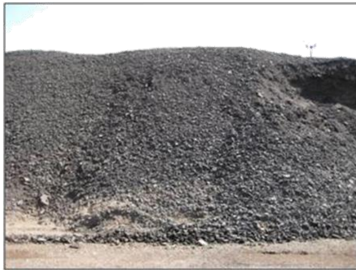
Şekil 2.5. Çeşitli boyutlarda işlenmemiş (RAP) frezelerinin bir stoğu [65].
