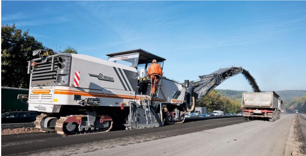
Şekil 1.1. Asfaltı öğüten ve kaplama yüzeylerini verimli bir şekilde kazın kazı makinesi (milling machine) [69].
