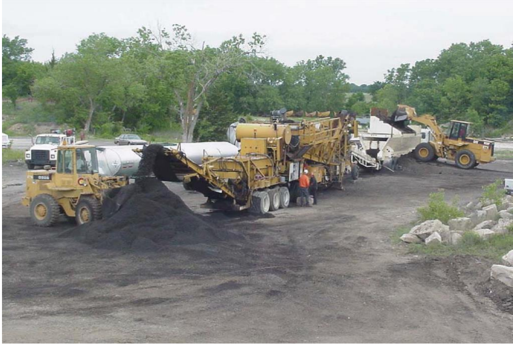
Şekil 1.11. Plentte soğuk geri dönüşüm yöntemi [42].
