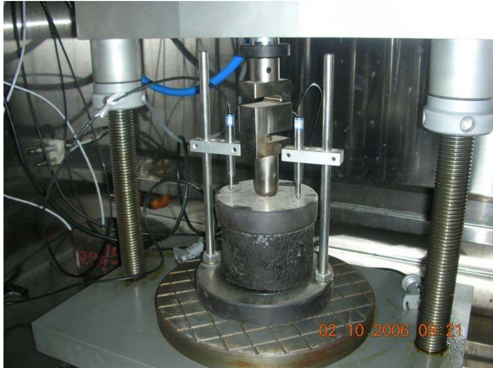
Şekil 5.42. Sünme rijitliği deneyi.
