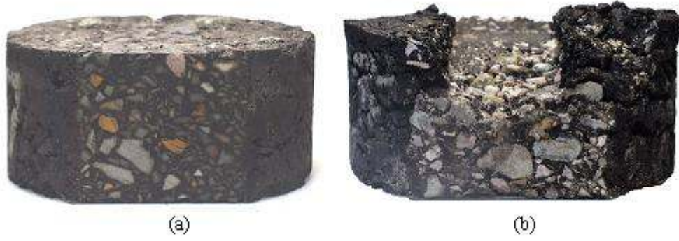
Şekil 3.1. (a) Soyulma olmamış numune, (b) Soyulma sonucu tekerlek izi oluşan numune.
