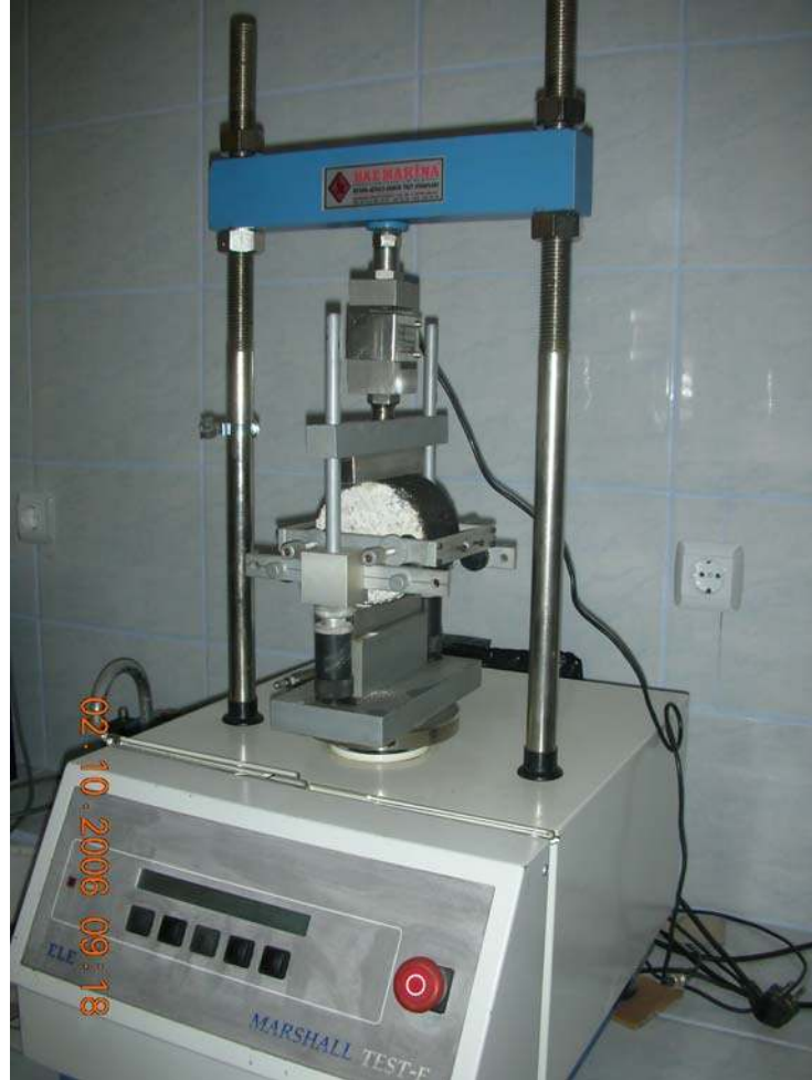
Şekil 5.32. İndirek çekme mukavemeti deney düzeneği.
