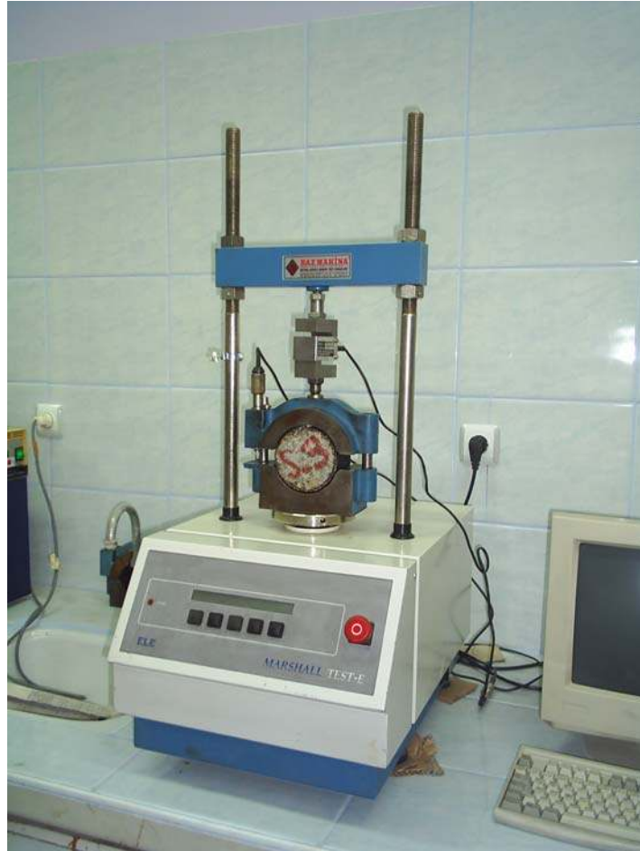
Şekil 5.29. Marshall deney cihazı.
