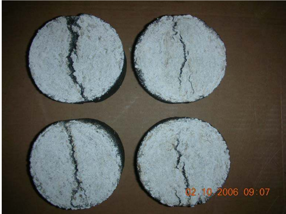
Şekil.5.58. Yorulma deneyi sonrası kırılmış numuneler.
