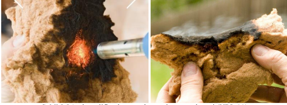
Şekil 2.24: ahşap lifi yalıtım malzemesi yangın deneyi (URL 22)
