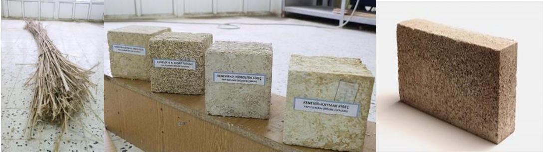
Şekil 2.28: kenevir sapı- kenevir ve bağlayıcılar ile elde edilen malzeme örnekleri- kenevir betonu (Demir, 2023)
