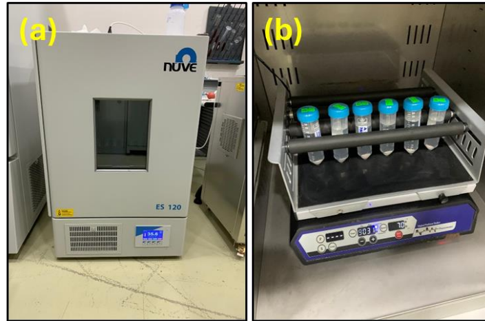
Şekil 4.6. LSW kodlu cam-seramiklerin in-vitro biyoaktivite testlerinin yapıldığı (a) Nüve ES120 inkübatör ve (b) çalkalayıcı sistem.
